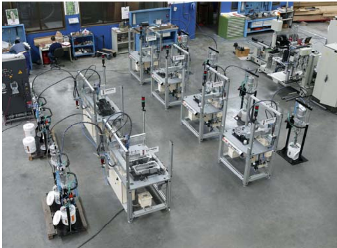
Conjunto varias máquinas de dosificado
